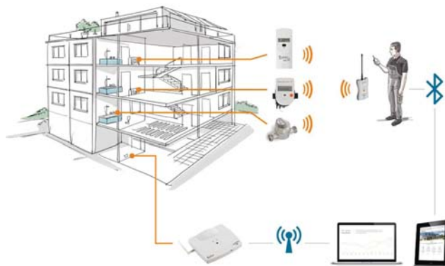
Obrázok 1 Zariadenia s diaľkovým odpočtom pomocou Sontex rádió
